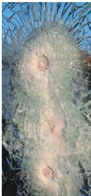
Bild 41. Glas testat för beskjutning för BR 6 NS.
